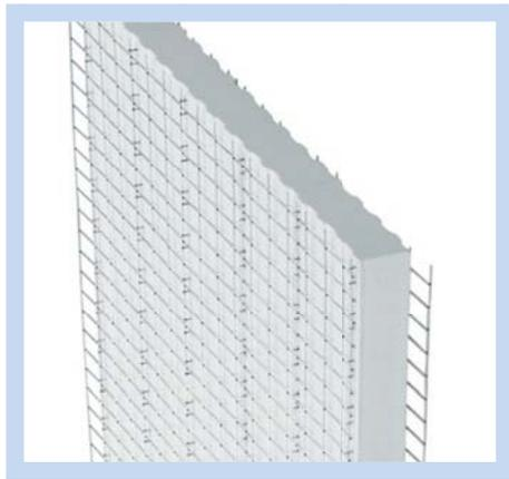
Para el uso estructural de este panel, el espesor de la lámina de poliestireno debe tener como mínimo 6 cm y la capa de revoque estructural de 3 cm (aproximadamente 2,5 cm sobre la malla) debe ser proyectada en cada cara del panel, debiendo alcanzar por lo menos una resistencia característica de 210 daN/cm<sup>2</sup> a la compresión.
